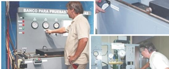
PRUEBA DE PRESION HIDROESTATICA HASTA 1500 kg/cm<sup>2</sup>.
