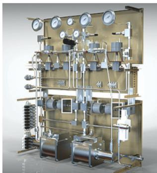
En la construcción de nuestros banco de prueba para válvulas y manifolds se utilizaron componentes de nuestra fabricación de la línea X-PRESS para 60.000 psi, niples, valvulas de aguja actuadas, uniones tees y codos. Los circuitos para control automático neumático se conectaron con tubos TPUR y uniones ROBOT-LINE.
