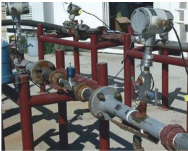
Las válvulas de aguja permiten controlar con eficacia desde la purga de una válvula tradicional reguladora de presión como la FR-67, pudiendo dirigir el fluido controlado haciendo la función de purga ambientalmente segura, hasta una regulación fija y de alto caudal, como la de un producto de inyección en equipo recuperación secundaria
