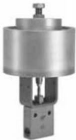
Son válvulas operadas a pistón, configuradas normalmente abiertas o cerradas, operadas con aire comprimido entre 30 psi y 150 psi. Entrada y salida de aire de 1/8" N.P.T. Pueden ser de simple y doble efecto, apertura o cierre por resorte o combinado resorte y accionamiento por aire.
